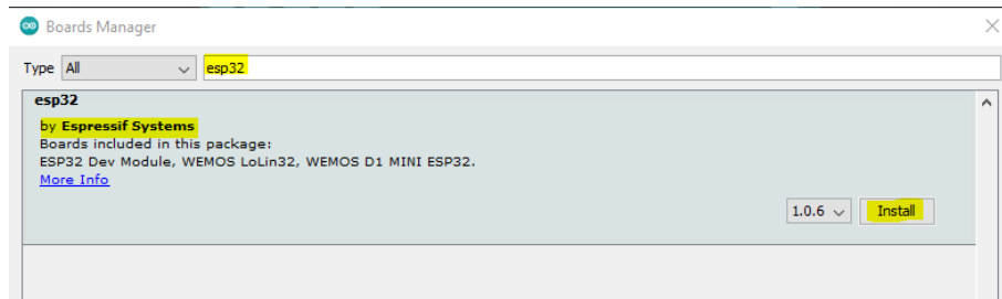
شکل ۴۸: پنجره نصب ESP32 در نرم‌افزار آردوینو
